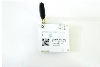
Fig.3. GSM module
